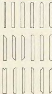
31. ábra Léckerítések építésére alkalmas, különböző formájú lécek
