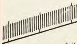
3. ábra Kerítés lejtős terepen a – a tereppel párhuzamosan építve, b – lépcsősen építve
